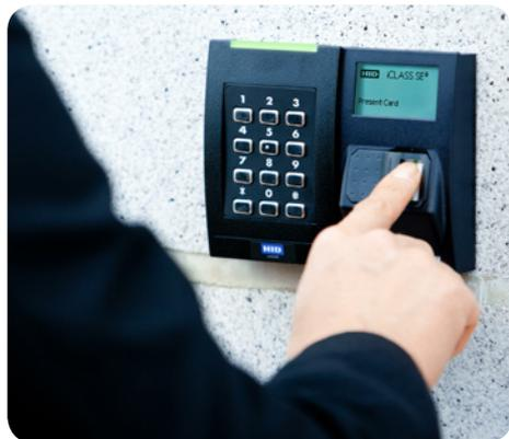
Устройство совместимо с программатором bioCLASS и соответствует стандарту совместимых биометрических шаблонов ANSI-378.
